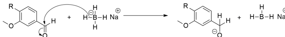
Figura 31 – Mecanismo proposto para reação de redução via NaBH 4 .
