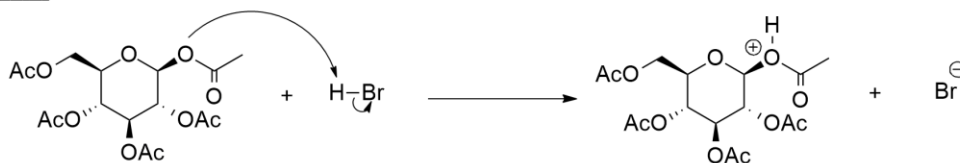
Figura 26– Mecanismo proposto para formação do brometo de glicosila.
