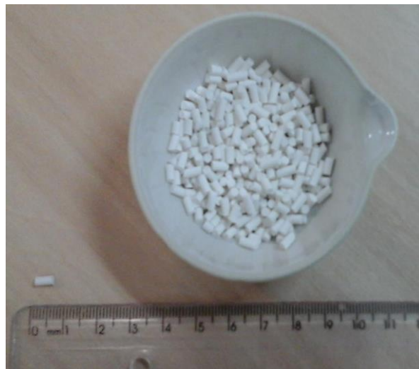
Figura 8 – Pellets cilíndricos (suportes) com 0,2 cm de diâmetro e comprimento de 0,4 a 0,5 cm.
