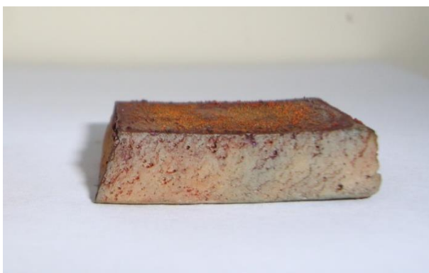
Figura 38 - Fotografia do sólido poroso de dióxido de titânio após mais 10 minutos de impregnação com corante verde
