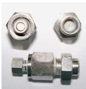
Figura 21 - Pré-coluna recheada com RAM-MIP-BSA Fonte: do autor.
