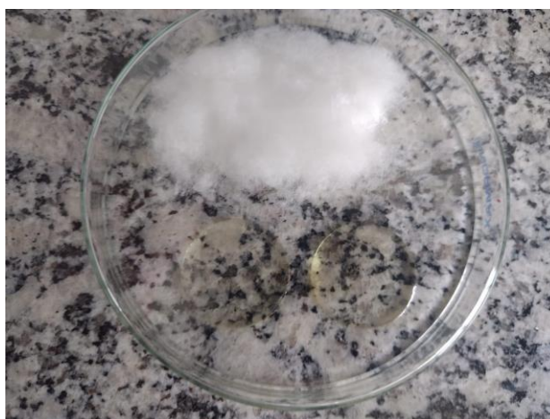
Figura 15 - Filmes poliméricos de PMMA com ácido \text{HAuCl}_4 \cdot \text{H}_2\text{O} em processo de secagem
