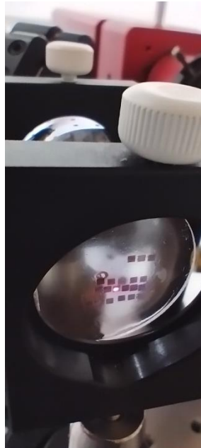
Figura 17 - Sistema óptico desenvolvido para gerar espectros de absorção
