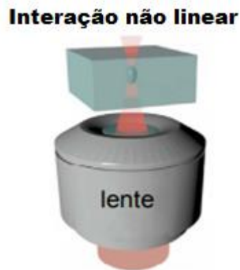
Figura 6 - Representação de um laser pulsado incidindo em uma amostra através de uma objetiva de microscópio.
