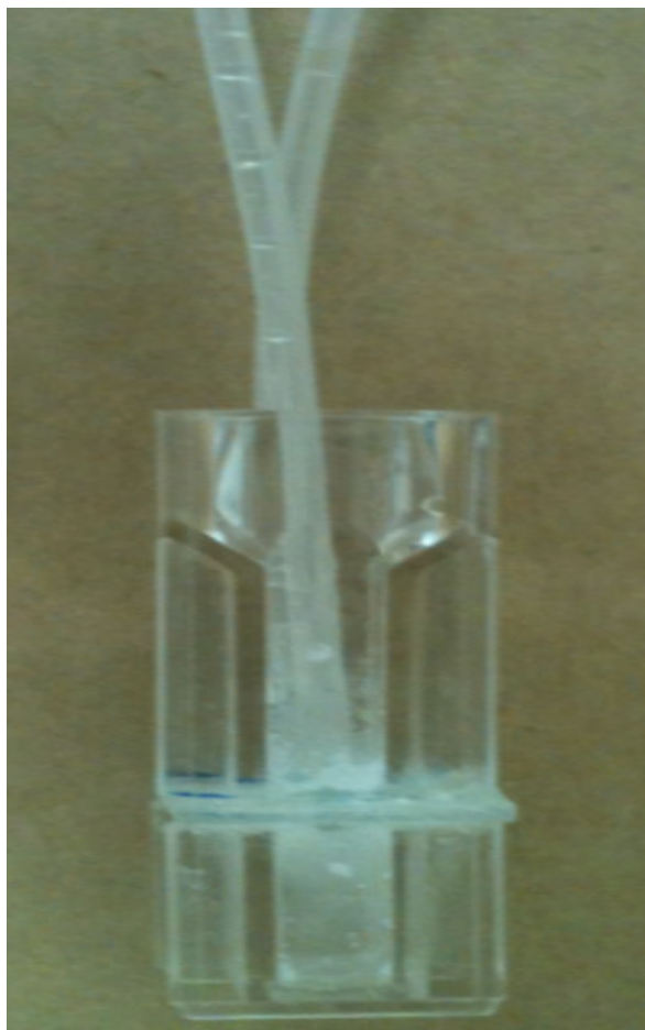
Figura 17 - Célula de fluxo de 0,48mL, confeccionada no Laboratório de química analítica da UNIFAL.
