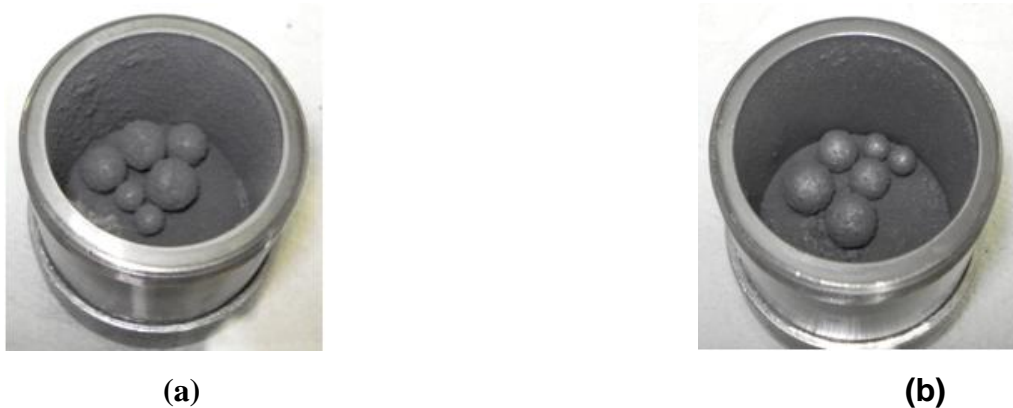
Figura 3 – Processo de moagem de alta energia com a utilização de 5% peso parafina
