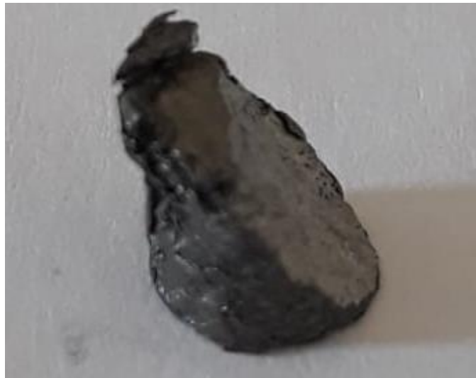
Figura 33 – Detalhe típico do corpo de prova da liga Ti-Si-Zr-B rompido após a realização do ensaio de compressão e utilizado para análises de superfície da fratura
