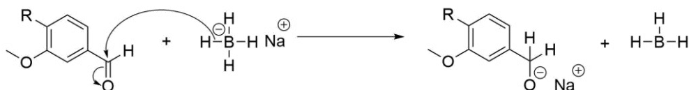
Figura 28 – Mecanismo proposto para reação de redução via NaBH 4 .
