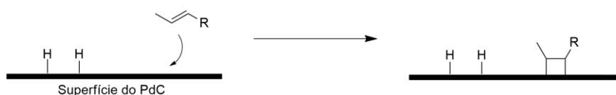
Figura 23 – Mecanismo proposto para hidrogenação catalítica.
