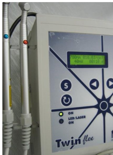
Figura 12 - Laser de diodo InGaAlP/GaAlAs, Twin Flex® (MMOptics, São Carlos, SP, Brasil).
