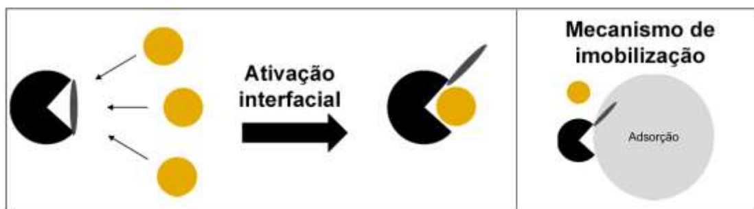
Figura 6 - Mecanismo da ativação interfacial das lipases.
