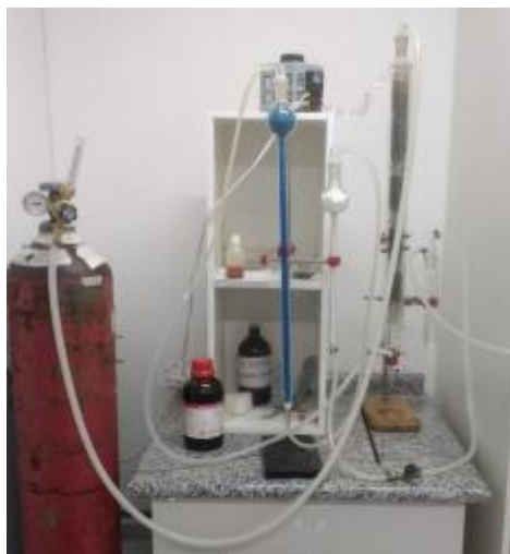
Figura 14 - Sistema de secagem de gás argônio.
