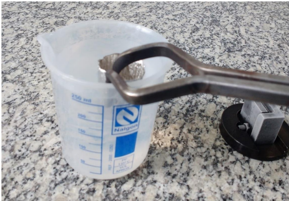
Figura 17 - Simulação do cadinho sendo mergulhado em solução salina a -15^{\circ}\text{C}
