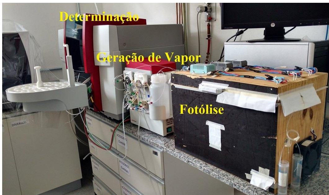
Figura 11 - Fotografia do sistema empregado para a especiação dos íons nitrito/nitrato.
