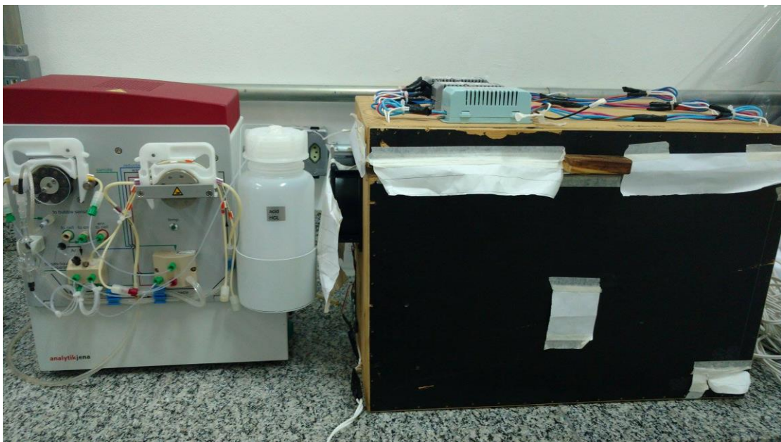
Figura 8 - Fotografia do sistema UV/CVG para a fotolítica redução/oxidação de compostos nitrogenados visando a geração de moléculas de NO.
