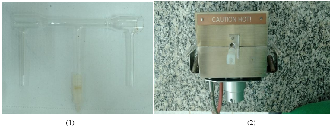
Figura 6 - Fotografias da cela de quartzo (1) envolta do sistema de aquecimento eletrotérmico (2).
