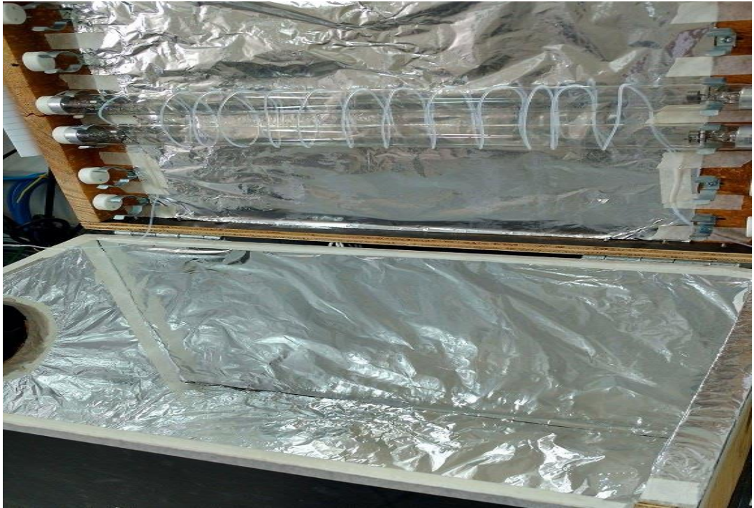
Figura 7 - Fotografia do reator fotoquímico utilizado para a fotólise (câmara fotolítica).
