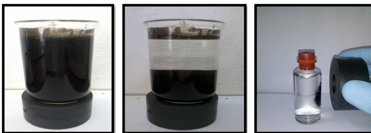
Figura 34: A) nanopartículas magnéticas em suspensão; B) nanopartículas magnéticas em repouso e C) nanopartículas magnéticas, sob a ação de um campo magnético externo
