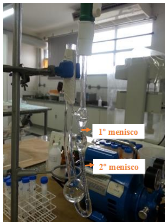
Figura 7 - Aparato utilizado para determinação da massa molar viscosimétrica da quitosana
