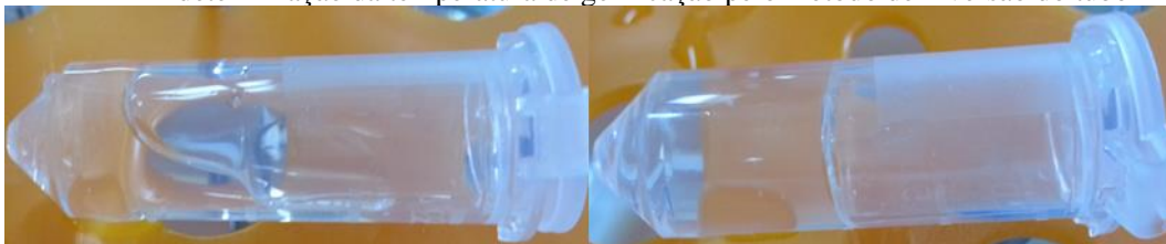
Figura 8 – Caracterização de amostra de HG gelificada (B) e não gelificada (A), durante determinação da temperatura de gelificação pelo método de inversão do tubo
