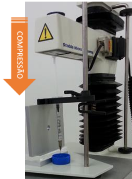
Figura 10 - Ilustração do teste de determinação da seringueabilidade
