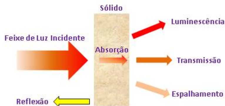
Figura 16 - Incidência de um feixe de luz num sólido.
