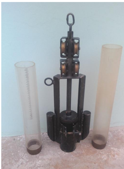
Figura 2. Coletor de sedimento tipo Kajak-Brinkhurst (Testemunho). Fonte: do autor
