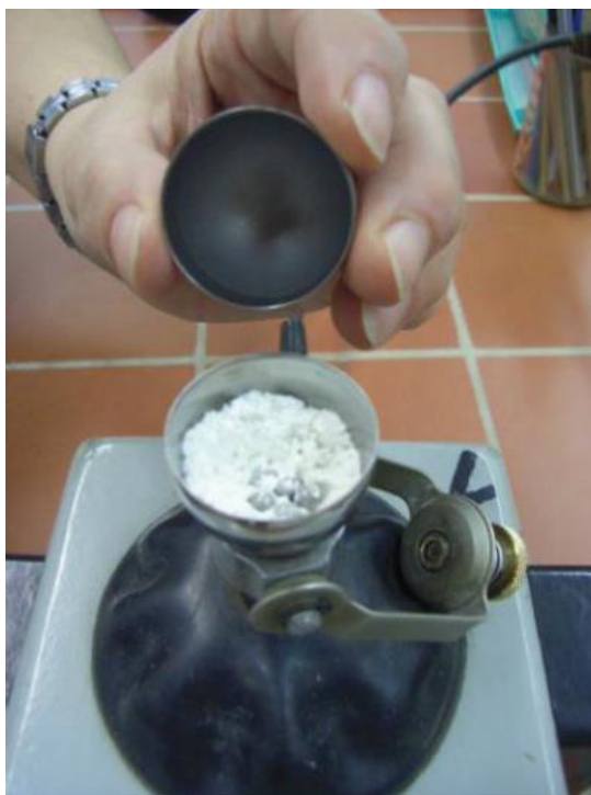
Figura 12 - Moinho de bolas utilizado na recristalização do FLU-H 2 O por mecanoquímica.
