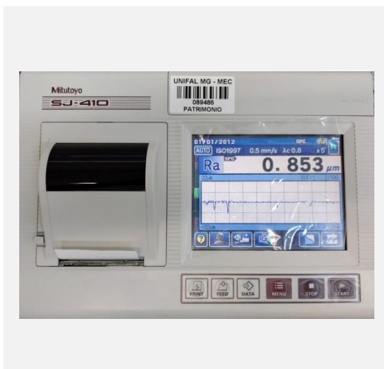
Figura 16- Rugosímetro Mitutoyo SJ- 400.
