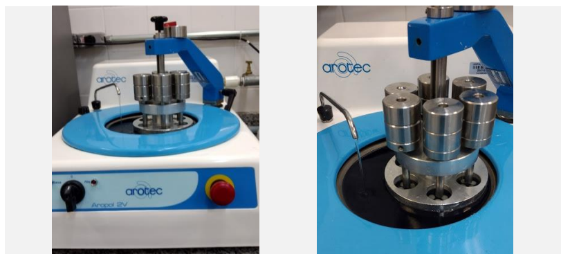
Figura 13- Politriz com as placas de corpo de prova sendo polidas. Fonte: Do autor.
