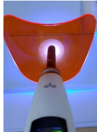
Figura 6- Fotopolimerização do corpo de prova. Fonte: Do autor.
