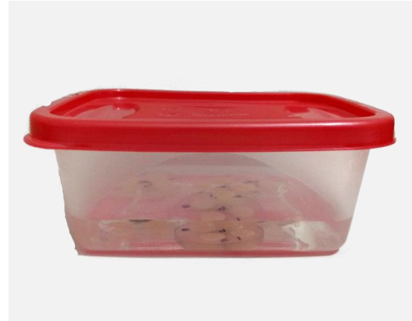
Figura 15- Corpos de prova imersos em água destilada.
