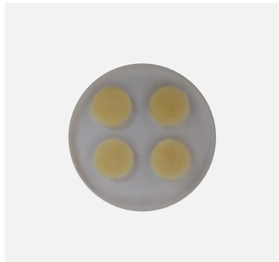
Figura 12- Corpos de prova embutidos. Fonte: Do autor.
