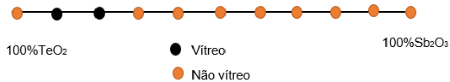
Figura 17- Diagrama binário para o sistema \text{TeO}_2\text{-Sb}_2\text{O}_3 .
